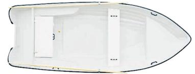
Die Basic 460 ist ausgelegt für Pinnensteuerung und kann optional mit zusätzlichem Steuerstand bestellt werden. Das Boot wird sehr geschätzt, da es durch den breiten Rumpf ungewöhnlich kippstabil ist. Durch das geringe Gewicht ist es optimal im Handling, egal ob zu Wasser oder an Land.
