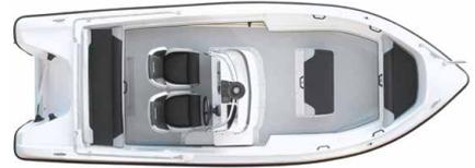
Die Classic 565 ist die Mittelkonsolenvariante basierend auf dem stabilen 5,60 m Rumpf. Der Steuerstand verfügt über eine große Windschutzscheibe, die auch die Passagiere auf der Heckbank gegen Fahrtwind schützt.
